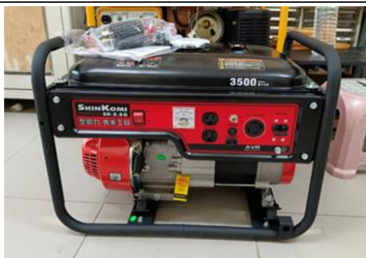
照片3：緊急發電機組
