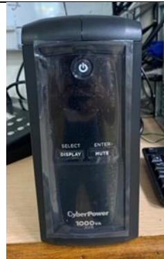
照片4：UPS 不斷電系統
